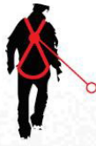
Caída FACTOR 2 el punto de anclaje situado bajo la conexión dorsal del arnés
