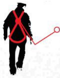
Caída FACTOR 1 punto de anclaje situado al mismo nivel del punto de anclaje dorsal del arnés
