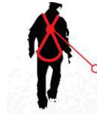
Queda FATOR 1 ponto de ancoragem situado ao mesmo nível do ponto de ancoragem
