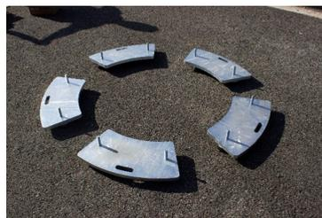
4. Colocar los 5 contrapesos restantes según la Fig. 4. Fijar el sistema mediante las tuercas de mariposa y apretar manualmente.
